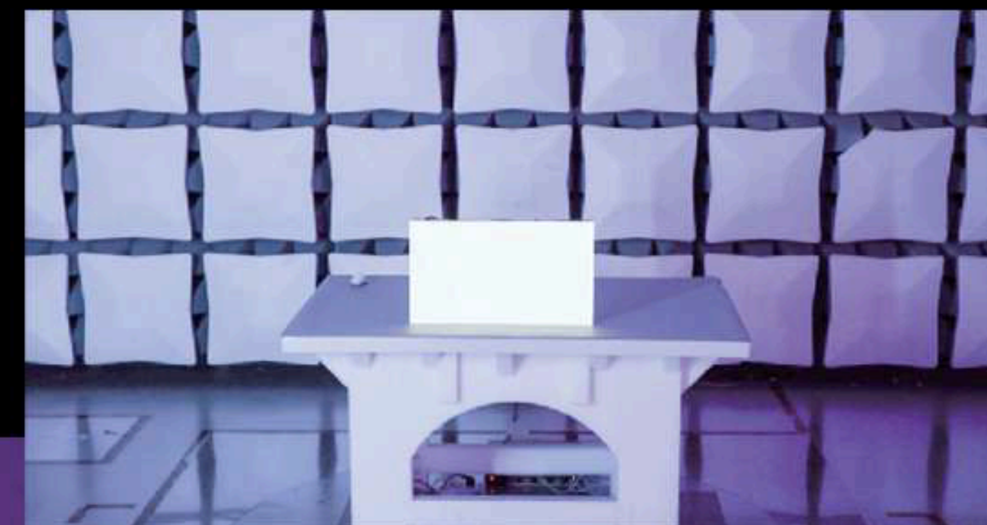
Prueba de RF en cámara anecoica
